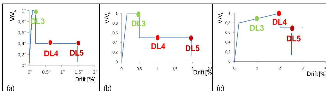
Fig. 3-3. Legami costitutivi taglio-drift per fasce murarie: a) fascia sorretta da arco in muratura; b) architrave in legno, acciaio o c.a.; c) architrave accoppiato ad elemento resistente a trazione.
