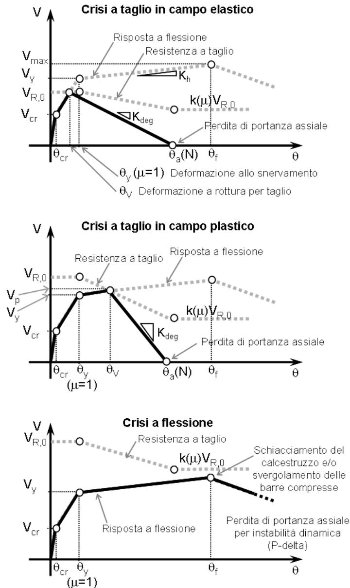
Fig. 4-1 Modalità di collasso di un elemento in cemento armato soggetto a flessione, taglio e sforzo normale.
