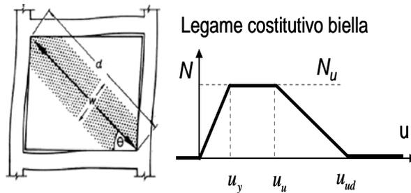
Fig. C-20 Legame costitutivo delle bielle equivalenti di tamponatura.
