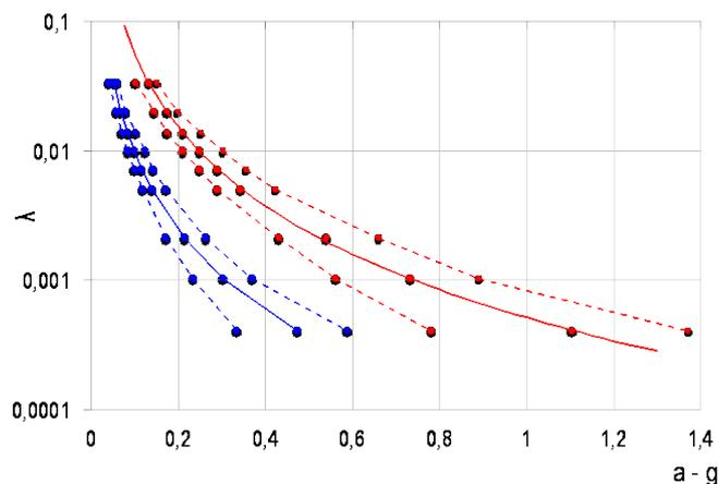
Fig. B-4 Curve di pericolosità media (tratto continuo) e frattile 84% e 16% (tratteggiato), in termini di accelerazione di picco al suolo (blu) e di ordinata spettrale  $S_a(T_1=0.26\text{ s})$  (rosso) per il sito in esame.
