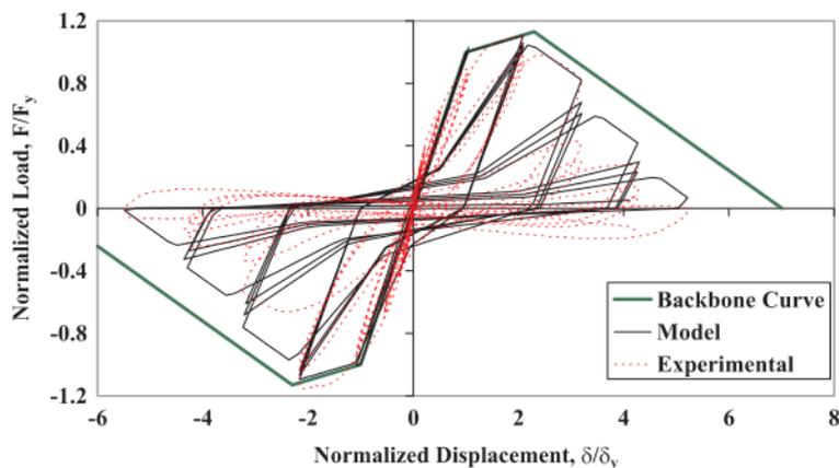
Fig. 4-6 Risposta ciclica sperimentale di un pilastro in c.a. di vecchia concezione e simulazione numerica (adattato da Ibarra et al 2005).
