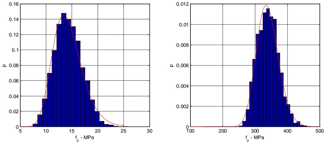
Fig. C-13 Proprietà dei materiali: istogrammi della frequenza relativa dei valori campionati e corrispondenti densità di campionamento (gli istogrammi sono ottenuti con tutti i valori campionati, cioè per tutti gli elementi in tutte le  $N$  simulazioni).
