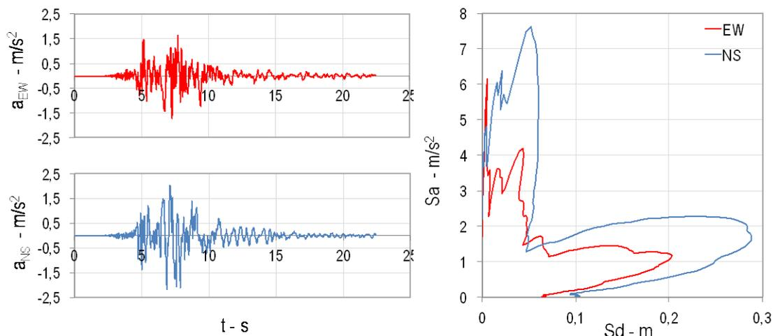
Fig. B-17 a) Accelogrammi relativi alla registrazione SAN0 del 29 Maggio 2012; b) spettri di risposta in formato ADRS.
