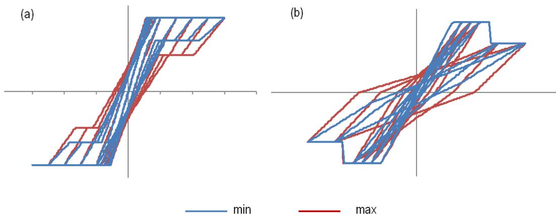
Fig. B-15 Effetto sulla risposta isteretica alla scala del singolo pannello dei parametri  $\alpha_m$ ,  $\gamma_m$  e  $\delta_m$ : caso di un maschio con risposta prevalente a pressoflessione (a) o taglio (b)
