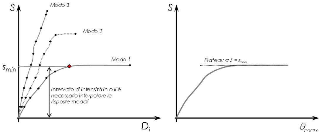
Fig. C-16 Le curve IDA dei modi (a sinistra) e quella dell'intera struttura (a destra).
