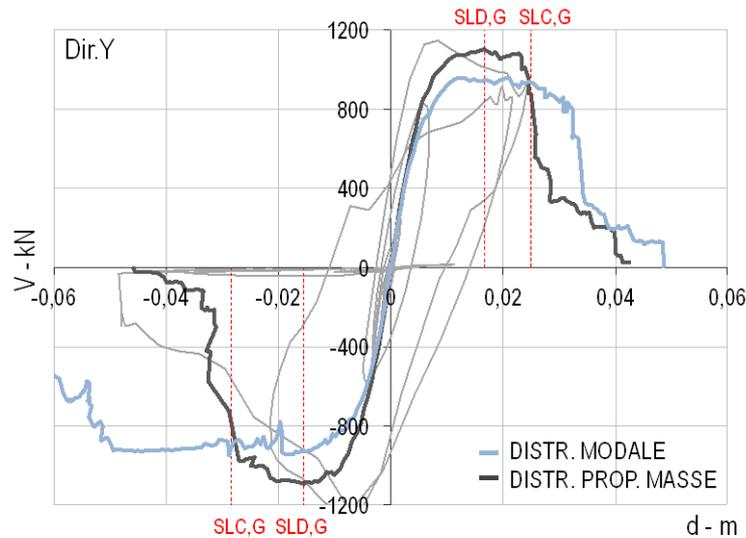
Fig. B-25 Risposta ciclica nelle due direzioni a seguito dell'applicazione della registrazione 1, scalata al valore  $S_a(T_1)=10.84 \text{ m/s}^2$ , e confronto con le curve ottenute dall'analisi statica non lineare.
