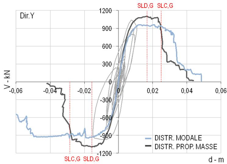
Fig. B-24 Risposta ciclica nelle due direzioni a seguito dell'applicazione della registrazione 1, scalata al valore  $S_a(T_1)=6.25 \text{ m/s}^2$ , e confronto con le curve ottenute dall'analisi statica non lineare.
