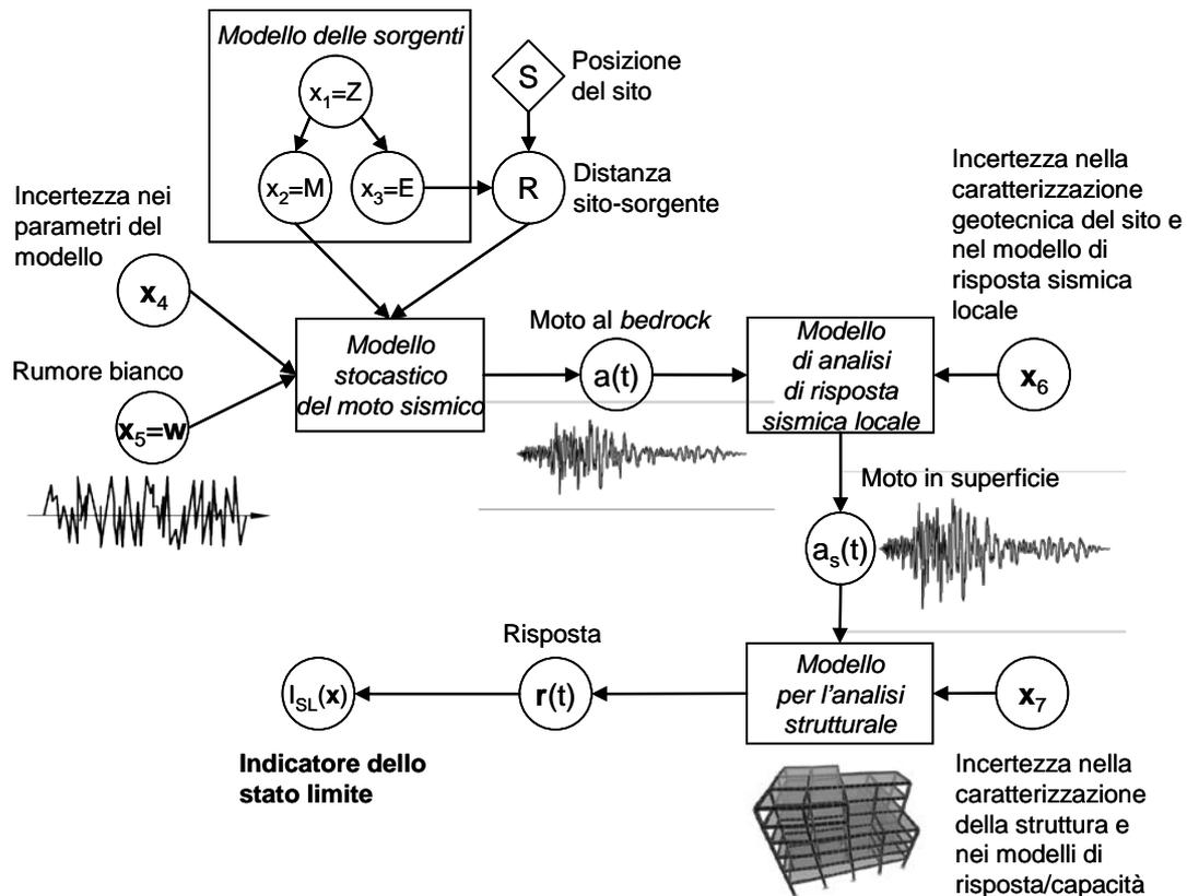
Fig. A-1 Schema del procedimento di simulazione con riferimento al generico evento.
