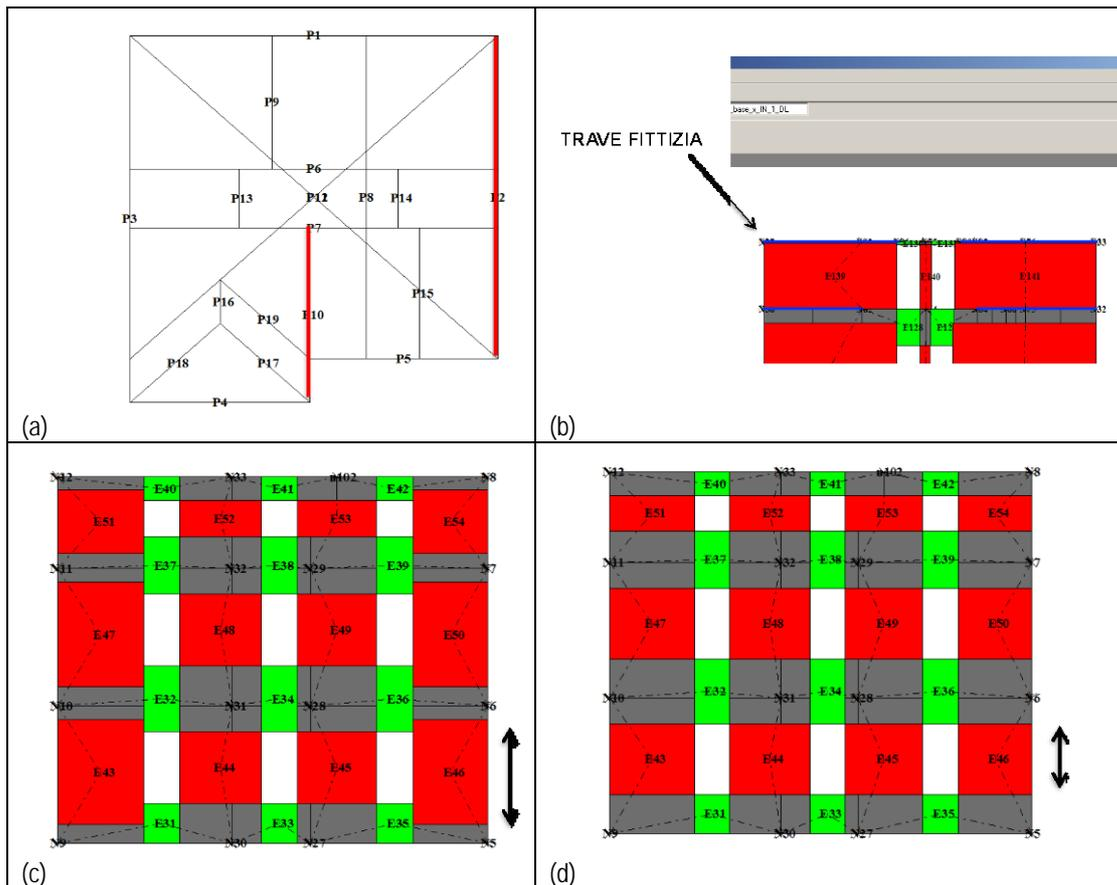
Fig. B-11. Modello strutturale a telaio equivalente (maschi in rosso; fasce in verde; nodi rigidi in grigio): (a) pianta con indicazione delle pareti illustrate; (b) in cui è stato considerato o meno l'effetto flangia in corrispondenza degli ammorsamenti; (c) due ipotesi assunte per la definizione della geometria del telaio equivalente: (c) Mesh-1 e (d) Mesh-2.
