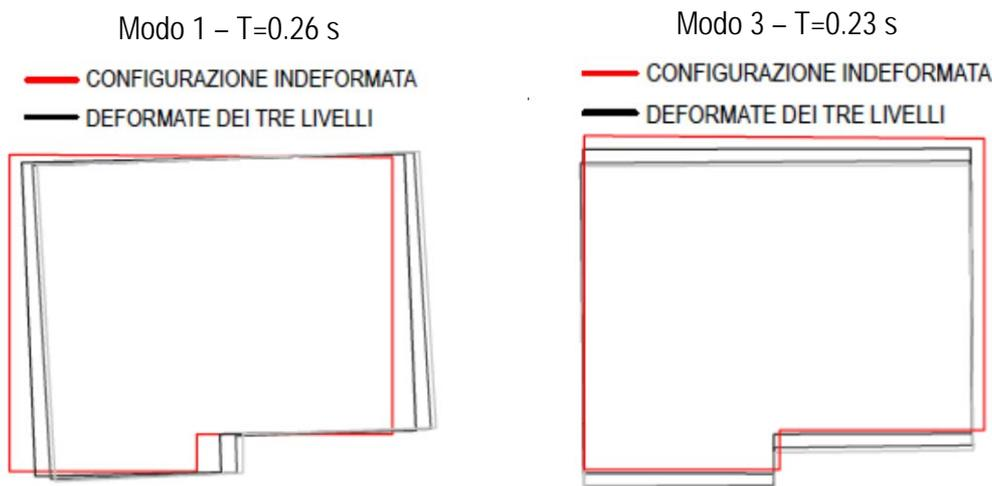
Fig. B-22 Deformate in pianta relative ai modi 1 e 3 per il modello Amm-1 (primo ramo dell'albero logico); i diversi colori sono associati ai differenti livelli dell'edificio.
