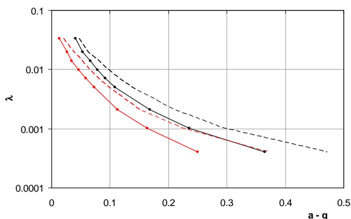
Fig. C-4 Curve di pericolosità mediana (tratto continuo) e frattile 84% (tratteggiato), in termini di accelerazione di picco al suolo (nero) e di ordinata spettrale  $S_a(T_1 \cong 1.52 \text{ s})$  (rosso) per il sito in esame.
