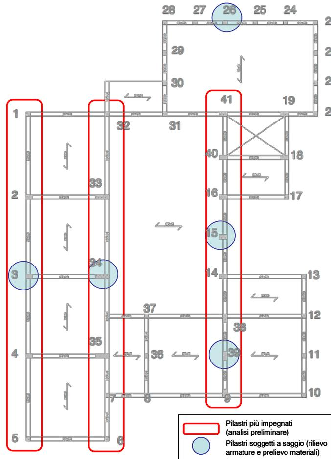
Fig. C-11 Posizione degli elementi soggetti a prova.
