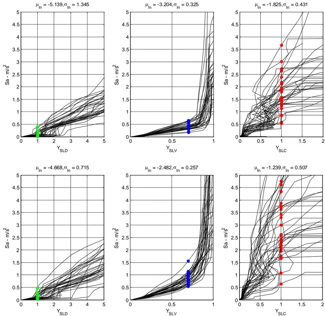
Fig. C-29 Modelli B (sopra) e C (sotto): Dettaglio delle curve di analisi dinamica incrementale, relazione intensità-indicatore di stato limite.
