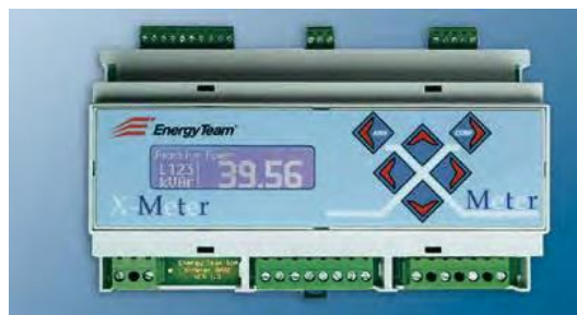
Analizzatore grandezze elettriche per monitoraggio/misurazione: registrazione dati.
