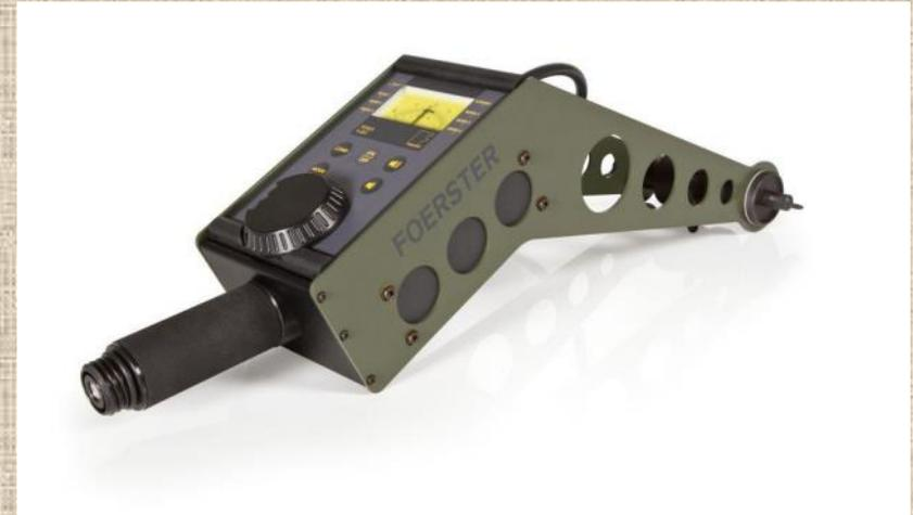
Magnetometri (*Passive Metal Detector*). Sono apparati che sfruttano la variazione del campo magnetico terrestre causata dalla presenza nel terreno di oggetti metallici e sono in grado di rilevarne la presenza anche in profondità.
