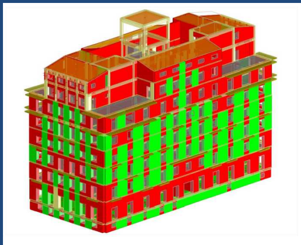
Modello 3D per analisi dinamica lineare – Analisi Modale
