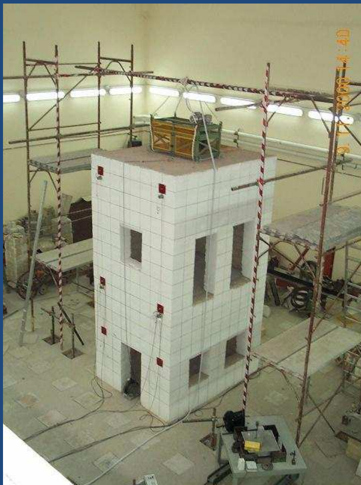
Modello in scala di piccola costruzione in tufo per prova dinamica con vibrodina
