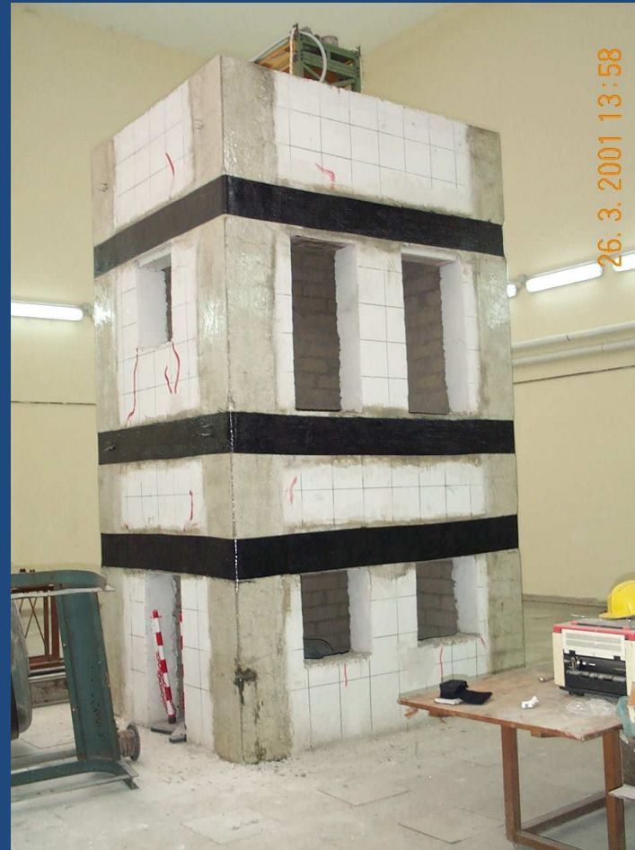
Ripetizione della prova dinamica dopo applicazione di cantonali in GFRP e fasciature di piano con CFRP
