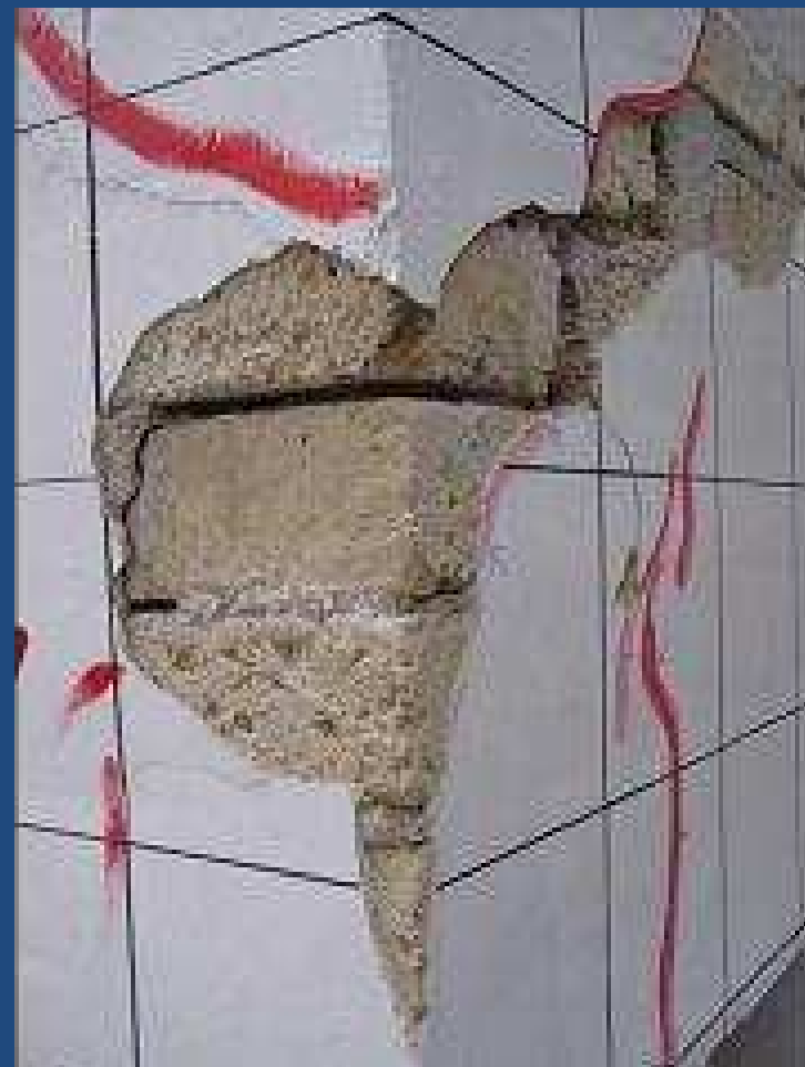
Modello in scala di piccola costruzione in tufo per prova dinamica con vibrodina
