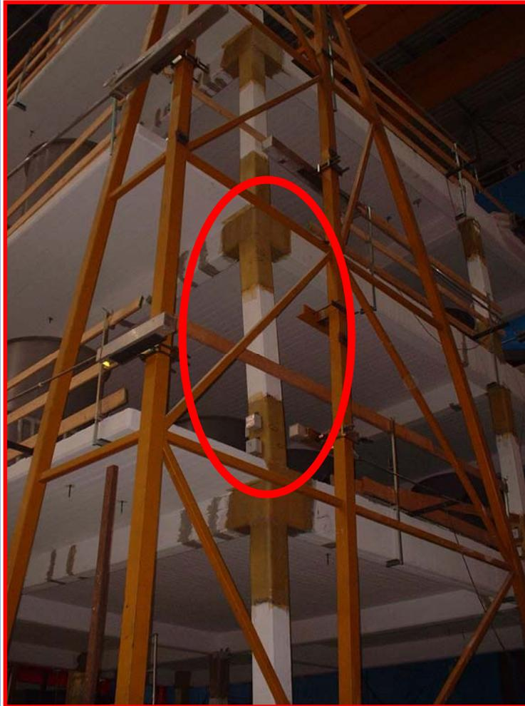
▪L'intervento con materiali compositi ha consentito un notevole miglioramento della capacità deformativa globale della struttura incrementando la duttilità delle cerniere plastiche e prevenendo la formazione di meccanismi di collasso fragile
