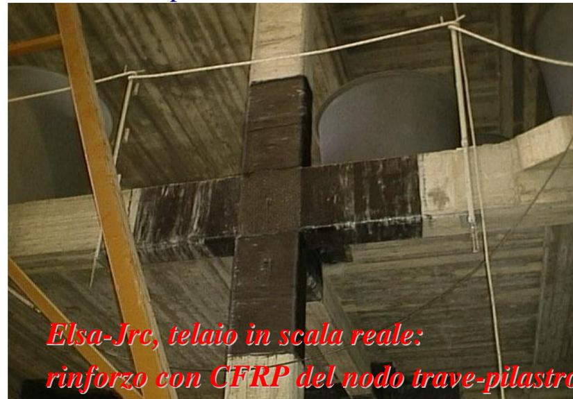
*Elsa-Jrc, telaio in scala reale:
