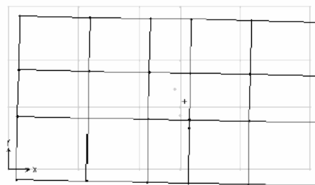
5° modo di vibrazione: Trasl. lungo Y ( T=0,176 s; \tilde{M}_{\%x}=3,5\% ; \tilde{M}_{\%y}=6,1\% )
