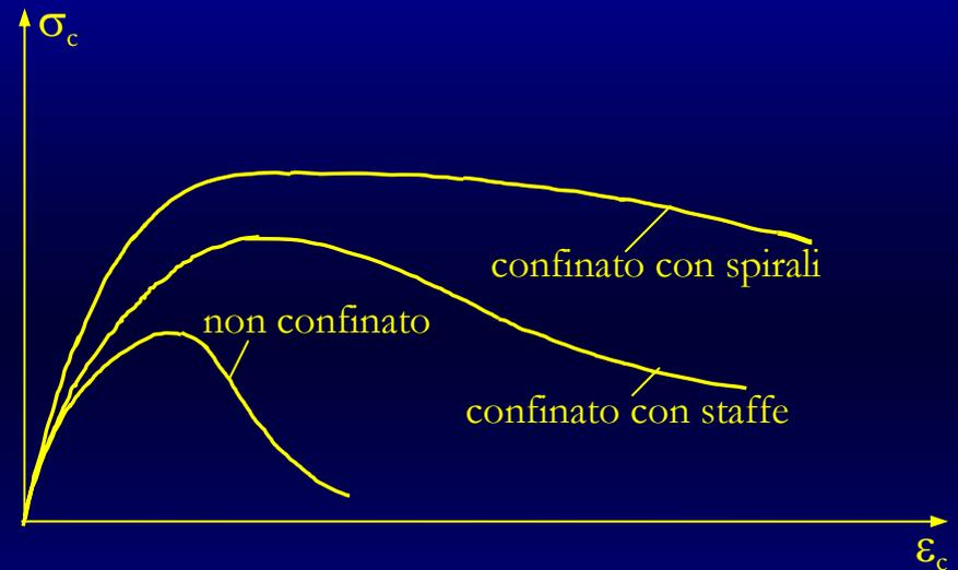
L'efficacia del confinamento dipende da passo e diametro delle staffe ma anche dalla disposizione delle armature longitudinali
