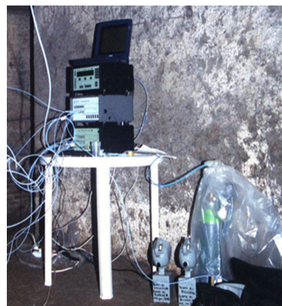
Teatro romano di Ercolano: indagini sulle infiltrazioni d'acqua ed analisi delle condizioni termoigrometriche e di qualità dell'aria
