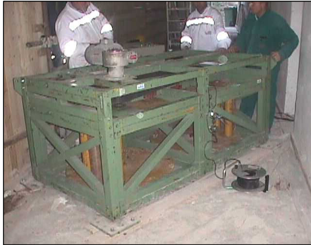
Vibrodina meccanica utilizzata come attuatore per i rilievi dinamici
