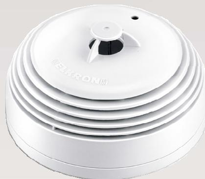
Il rivelatore Ottico/Termico digitale FDOT500 è composto da un rivelatore di fumo basato sul principio di funzionamento dell'effetto tyndall e da un rivelatore termico con soglia di intervento fissa a 58°C .
