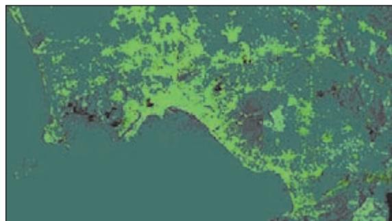
A sinistra: Golfo di Napoli - Velocità media di deformazione in mm/anno in direzione verticale sovrapposta all'immagine Sar. Copertura 10 mila Km<sup>2</sup>, risoluzione (100x100m)
