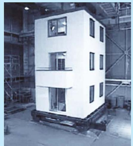
Figura 19. Prava su tavola vibrante di un edificio leggero isolato con dispositivi CLB.
