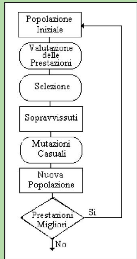
Figura 5. Struttura generale di un algoritmo genetico.
