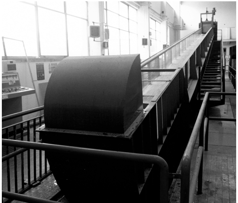
Canaletta a fondo inclinabile nell'Istituto di Idraulica
