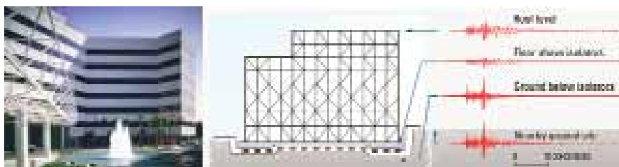
Figura 4. UCLA University Hospital: registrazioni accelerometriche sull'edificio. Terremoto di Northridge, 1994.
