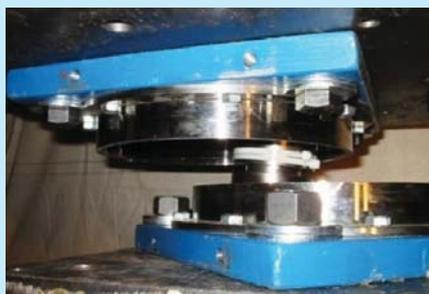
Figura 8. Isolatore DCFP durante prova ciclica.
