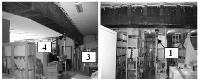
Figura 14: Disposizione dei sensori differenziali impiegati per la rilevazione degli abbassamenti della trave e dei solai ad essa adiacenti.
