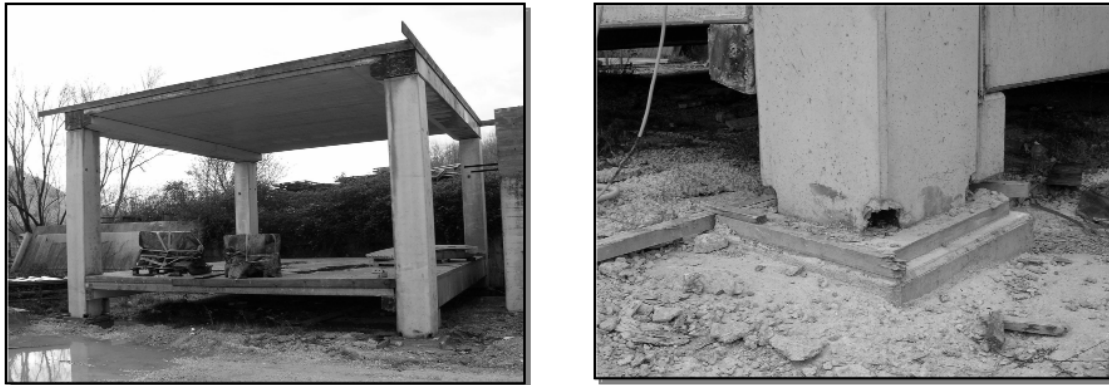
Figura 3 – Modello a base fissa – particolare attacco pilastro
