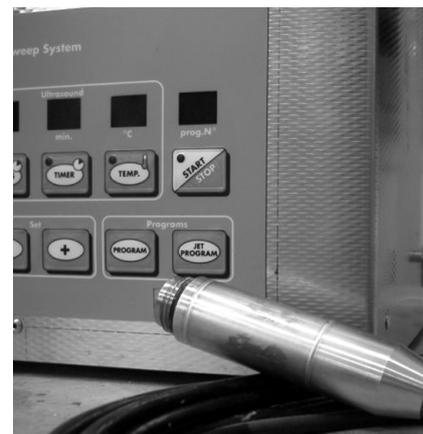
Fig. 8. Trasduttore di pressione per l'acquisizione dei dati.
