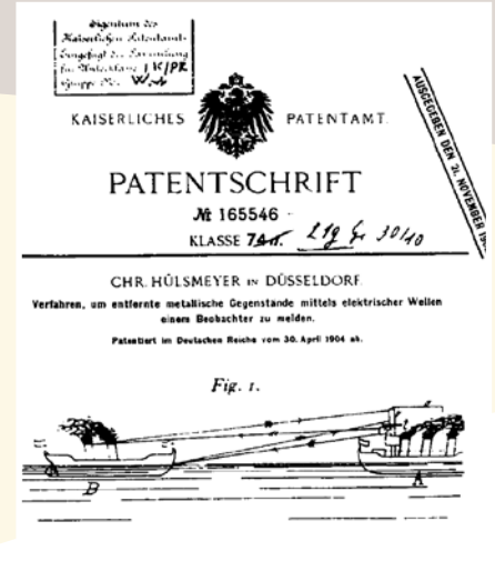
Fig. 2 – Brevetto di Hulsmeier sulla rilevazione di oggetti metallici tramite onde elettromagnetiche
