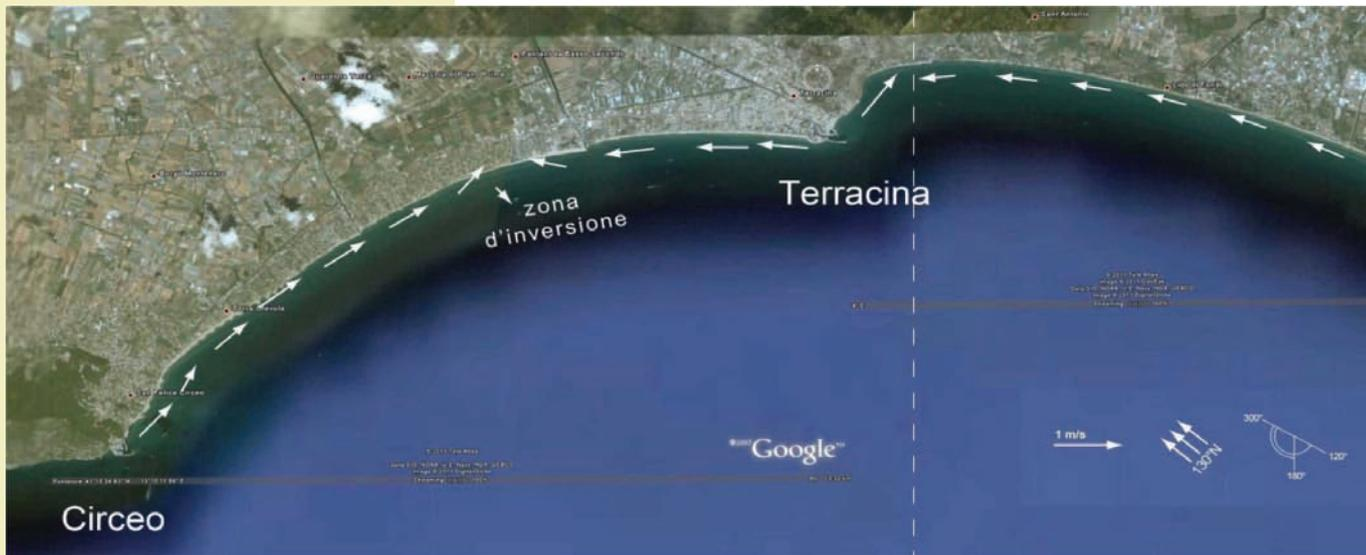
Figura 3b. Intensità delle correnti litoranee. Inversione a ovest di Terracina. Particolare di Figura 3a – onde da 130°.
