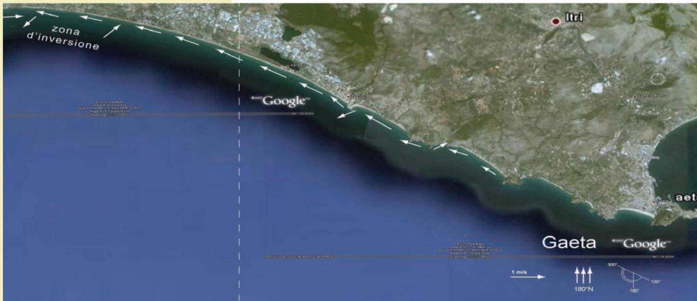
Figura 4c. Intensità delle correnti litoranee. Particolare di Figura 4a – onde da 180°.
