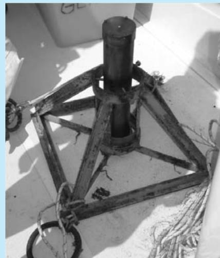
Figura 12. Il sensore di pressione.
